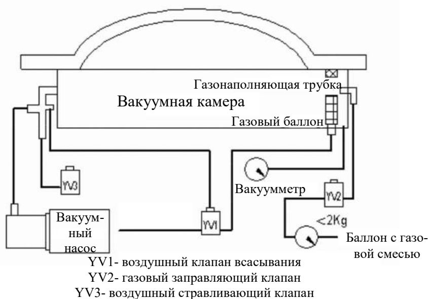
Схема вакуумного упаковщика с системой газации
